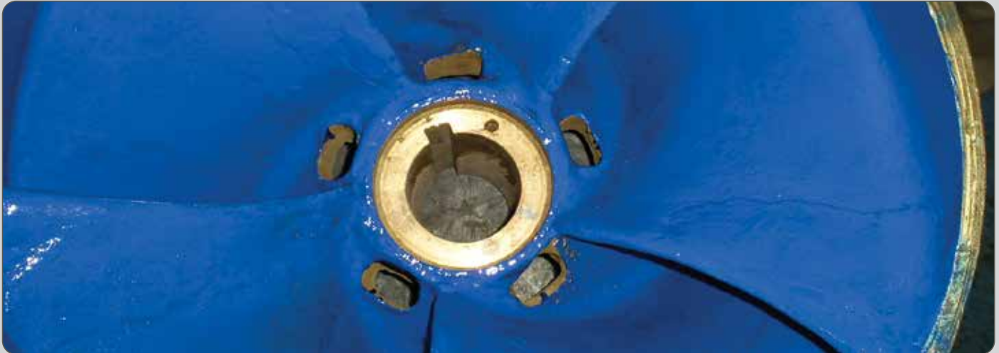
ROTOR DE BOMBA REVESTIDO COM PLASTEEL CERÂMICO AZUL.
