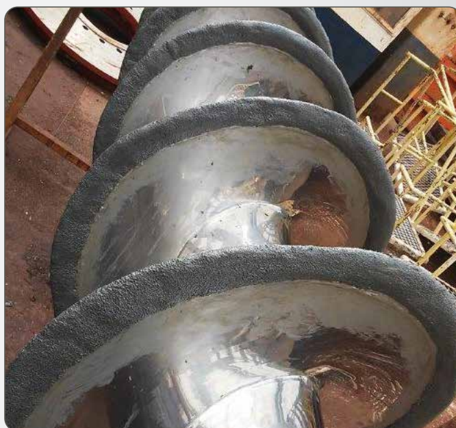
PROTEÇÃO DE ROSCA TRANSPORTADORA COM PLASTEEL DIAMANTADO.
