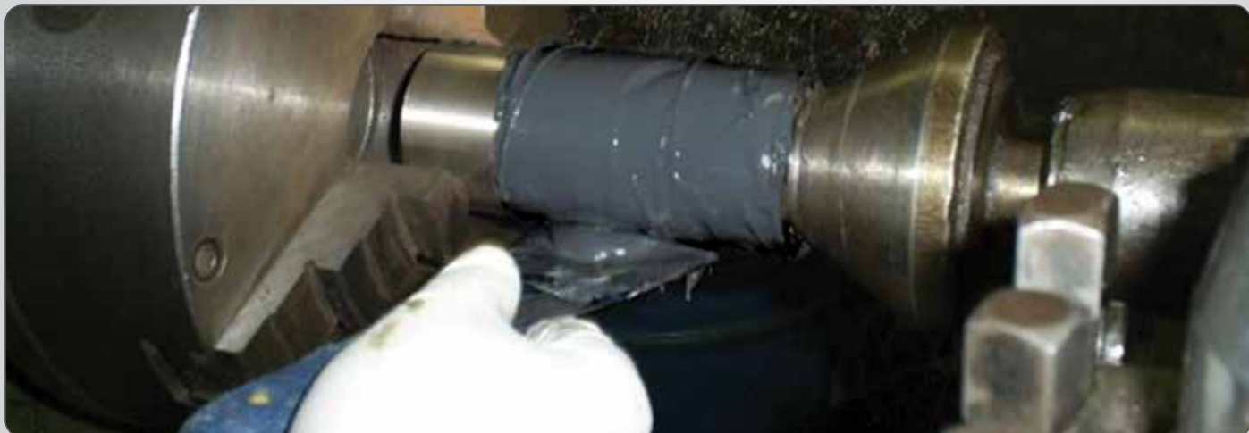
RECUPERAÇÃO DE EIXO COM O PLASTEEL MASSA 4:1
