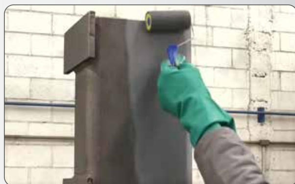
GALVALUM SENDO APLICADO COM ROLO DE PINTURA
